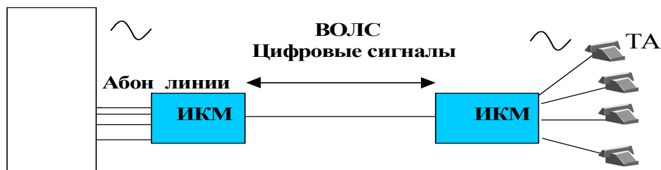
Рисунок 1 – Использование ВОЛС для предоставления услуг телефонной связи с аналоговым подключением к АТС
